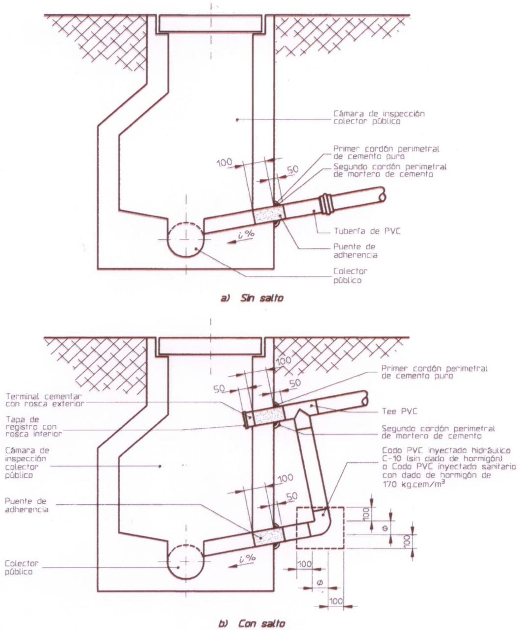
Figura 4 - Esquema empalme UD a cámara de alcantarillado público
